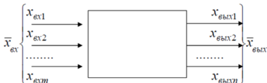
Рис. 2. Элемент системы автоматического регулирования с несколькими входными и выходными величинами.
