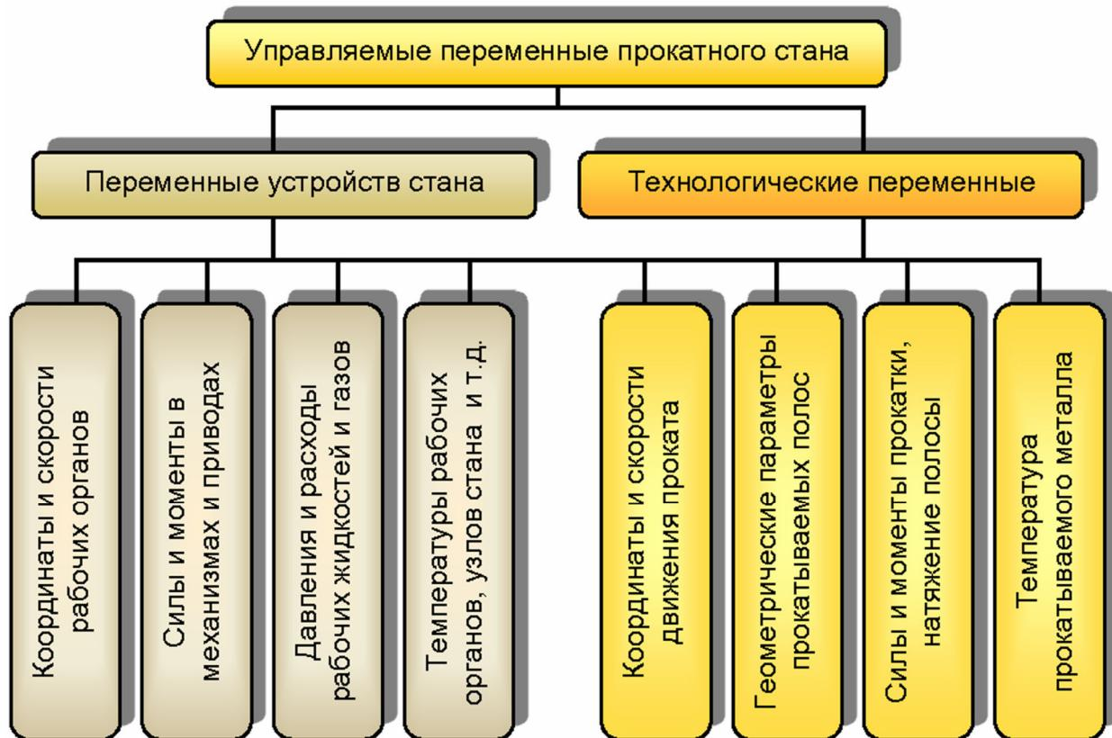
**Рис. 3.1.** Управляемые переменные прокатного стана
