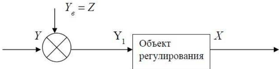
Рис. 5. Структурная схема одномерного объекта регулирования:
