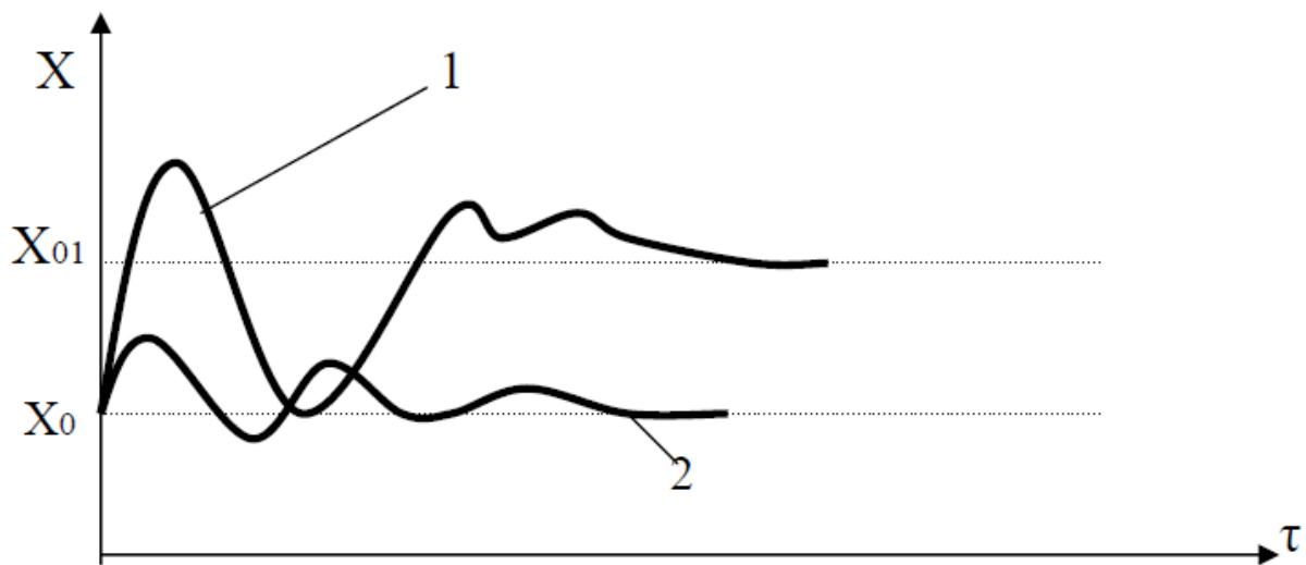
Рис. 17 . Графики переходных процессов в астатической системе.
