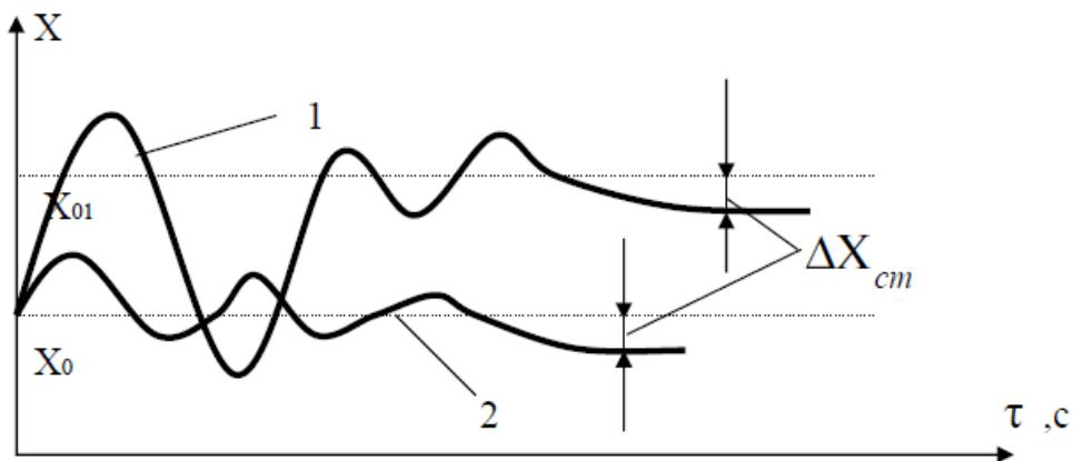
Рис. 18. Графики переходных процессов в статической системе:
