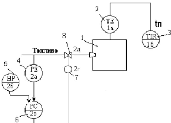
Рис 15 . Схема функциональной структуры разомкнутой САР температуры в печи с регулированием по возмущению.
