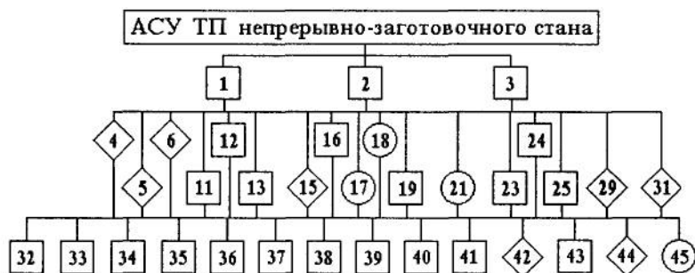
Рис 3. Схема АСУ ТП непрерывно-заготовочного стана: 1 - ИУК учета валкового хозяйства цеха; 2 - ИУК слежения за металлом; 3 - ИУК учета производства;
