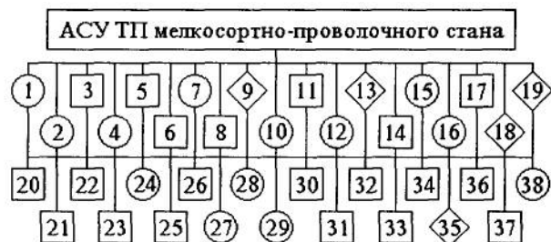
Рис 4. Схема АСУ ТП мелкосортно-проволочного стана: системы: 1 - управления складом заготовок; 2 - управления транспортным режимом; 3 - автоматического управления скоростным режимом; 4 - автоматической установки межвалковых зазоров; 5 - аварийного пореза проката; 6 - автоматического управления зачисткой передних концов проката; 7 - раскря проката перед холодильником; 8 - управления процессом термоупрочнения на мелкосортном стане; 9 - управления процессом на проволочном стане; 10 - управления транспортными механизмами участка охлаждения; 11 - автоматического управления раскромом на ножницах холодной резки; 12 - автоматизированного учета прокатной продукции дифференцированной по группам прочности; 13 - управления линиями для проектирования, маркировки и обвязки; 14 - измерения массы пакета прутков и бунтов; 15 - учета расхода энергоносителей по стану; 16 - управления складом готовой продукции; 17 - информационного сопровождения металла; 18 - диагностики неисправностей технологического оборудования и систем автоматизации; 19 - сбора и передачи данных о производстве проката в АСУП;
