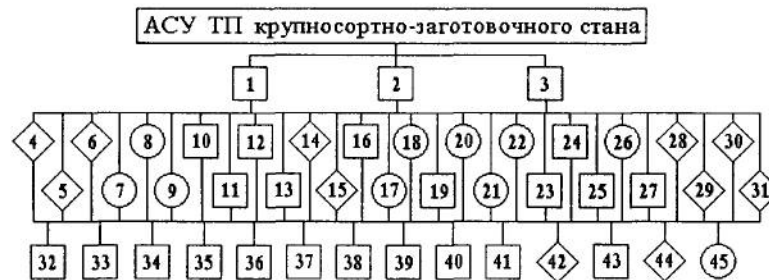
Рис 1. Схема АСУ ТП крупноразмерного заготовочного стана: 1 - ИУК учета валкового хозяйства цеха; 2 - ИУК слежения за металлом; 3 - ИУК учета производства;
