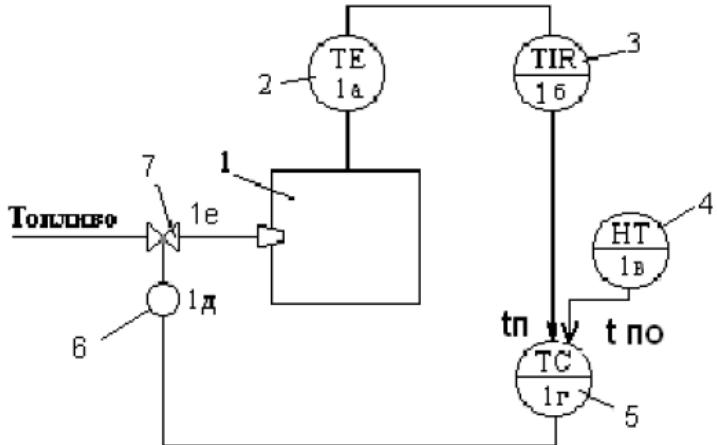
Рис 13.Схема функциональной структуры замкнутой САР температуры в печи.
