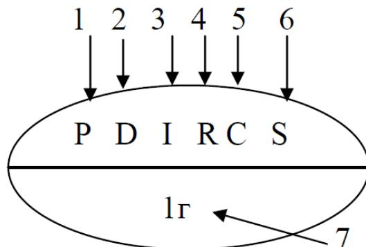
1. Основное обозначение измеряемой величины: Р – давление. 2. Уточняющее обозначение измеряемой величины: D – перепад. 3, 4, 5, 6 - Функциональные признаки прибора: I – показание, R–регистрация, С – регулирование, S – переключение. 7. Позиционное обозначение прибора, включающееся в спецификацию – 1г. Следовательно, прибор, показанный на примере, предназначен для показания, регистрации, регулирования и переключения при определенном значении перепада давления. Прибор устанавливается на щите.
