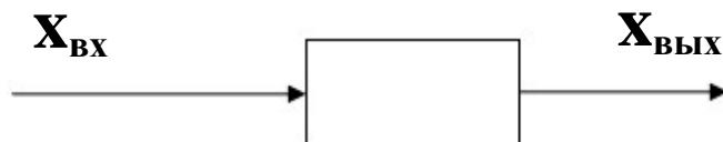
Рис. 1. Элемент системы автоматического регулирования с одной входной и одной выходной величинами.
