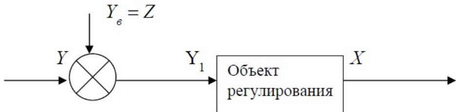
Рис. 5. Структурная схема одномерного объекта регулирования:
