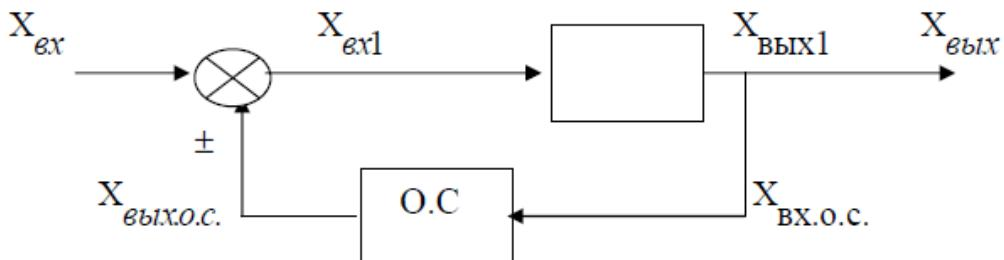
Рис 3. Элементы системы автоматического регулирования с обратной связью
